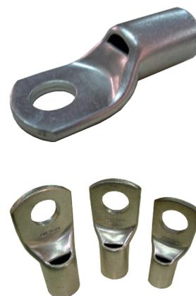
Ej.: YAV35M12 - Terminal de compresión de cobre estañado para cable de 35 mm<sup>2</sup> con orificio de 1/2 pulgada
